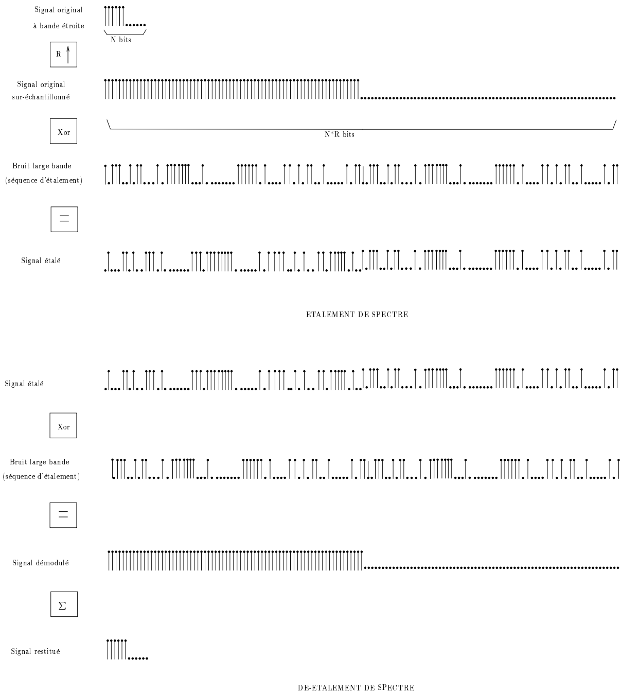
FIG. 5 – Principe d'étalement de spectre par séquence directe
