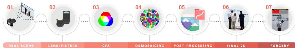
Figure 14 : pipeline d'acquisition d'une image numérique.
