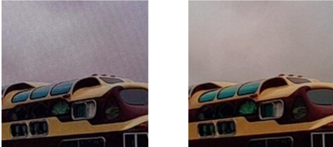
Figure 42 : Comparaison entre une image recapturée à partir d'un écran LCD (à gauche) et une image recapturée à partir d'un écran OLED (à droite). On distingue des motifs au niveau du ciel sur l'image recapturée à partir d'un écran LCD.
