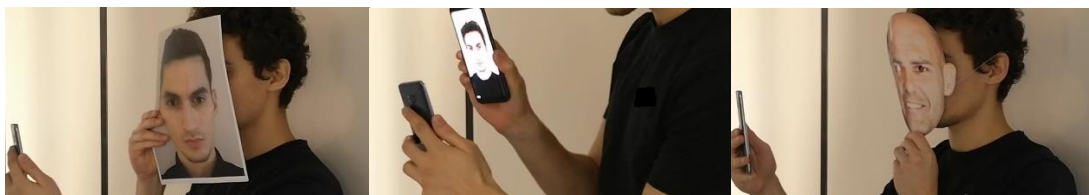
Figure 15 : attaques de présentation faciale, en présentant une photo imprimée (à gauche), en présentant une vidéo (au centre) et en présentant un masque (à droite).
