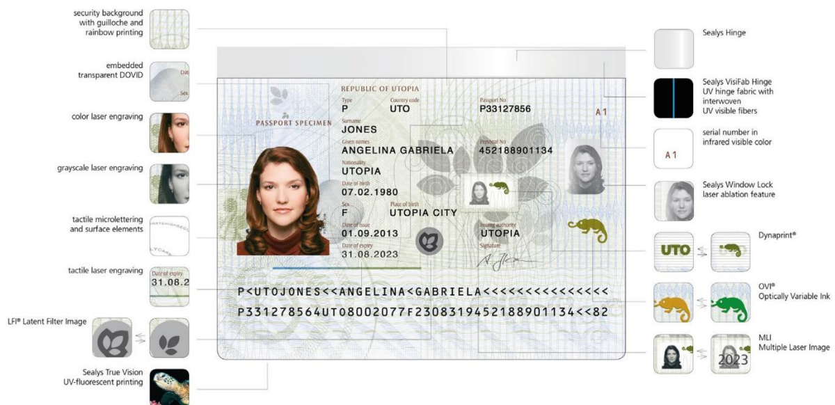
Figure 19 : les différents éléments de sécurité pour empêcher ou rendre difficile la falsification des documents d'identités.
