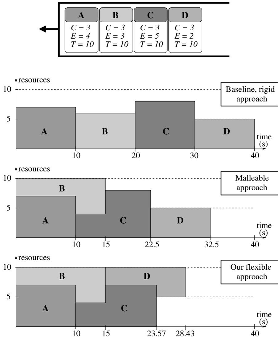
Fig. A.1 Exemples d'ordonnancement des demandes: (haut) rigide, (moyen) malléable, (bas) flexible approches.
