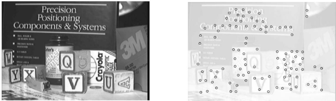
**Figure 18:** Image test et caractéristiques KLT correspondantes détectées.
