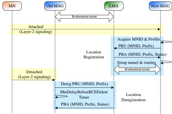
**Figure 2. PMIPv6 Sequence Diagram**
