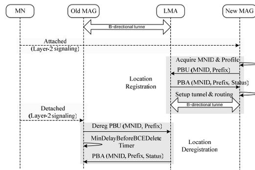
**Figure 2. PMIPv6 Sequence Diagram**
