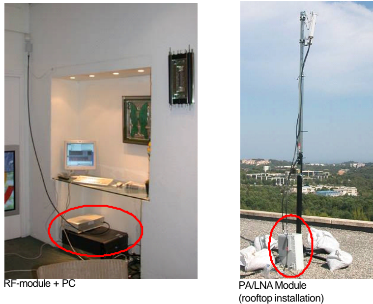
Figure 4.3. Exemples de déploiement de passerelles radio
