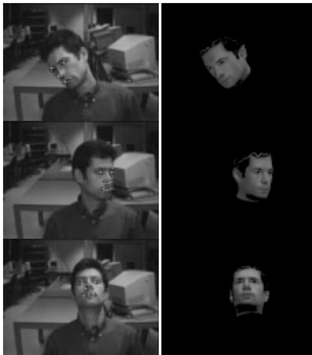
FIG. 1 – Résultats de l’algorithme de suivi vidéo (colonne gauche) et rendus synthétiques (colonne droite) — Le modèle CYBERWARE de J.-L. Dugelay nous a été fourni par le laboratoire LUAP de l’Université Paris 7.
