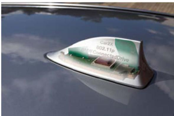
In dem Forschungsprojekt "E-safety vehicle intrusion protected applications (EVITA)" entwickelten die Forscher spezielle Security- und Privacy-Mechanismen, die den sicheren und privaten Austausch von Informationen im Fahrzeug, zwischen Fahrzeugen untereinander, aber auch zwischen Fahrzeugen und der Verkehrsinfrastruktur, z. B. für den Bereich der Car-to-X-Kommunikation, ermöglichen. Das von der Europäischen Kommission
