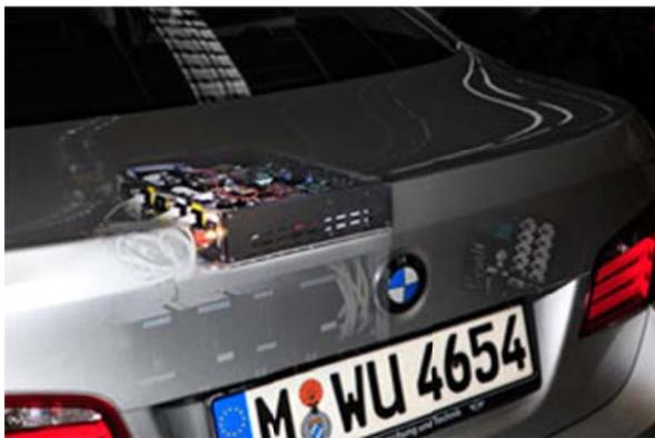
*Forschungsprojekt EVITA - die Plattform ist im Kofferraum des Forschungsfahrzeugs BMW 5er verbaut*
