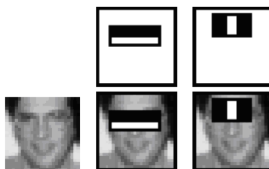
FIGURE 2.11 – Deux premiers/meilleurs descripteurs utilisés pour la détection de visages par l'algorithme de Viola-Jones. Les yeux semblent être la partie du visage permettant la meilleure discrimination par rapport au 'reste du monde'.
