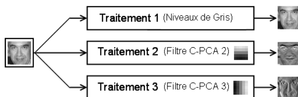
FIGURE 4.9 – Exemples de traitement d’image utilisés pour le système de détection par l’association de MLP utilisant la C-PCA. La première image correspond à l’image en Niveaux de Gris, la seconde à l’image filtrée par le second filtre de la C-PCA et la troisième par le troisième filtre de la C-PCA.
