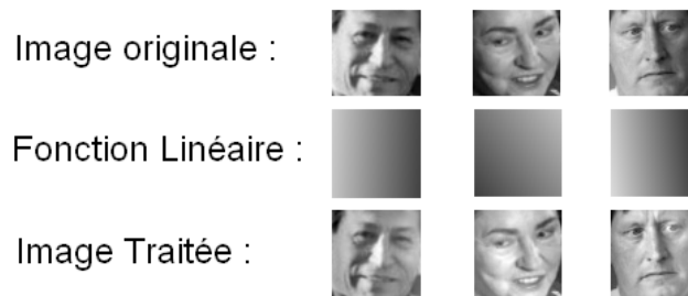
FIGURE 3.17 – Exemple d’application de la correction du gradient d’illumination sur trois images de visages. Nous pouvons constater que cette méthode permet de minimiser les effets dues aux éclairages latéraux.
