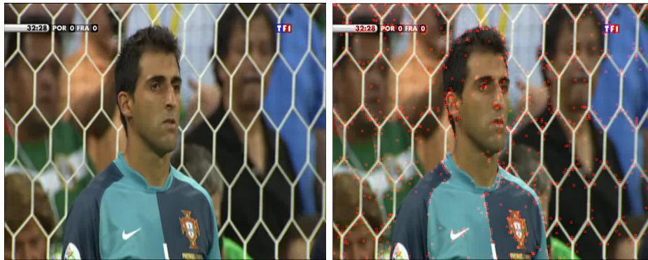
FIG. 4.17 – Exemple d'erreur obtenue pour une image appartenant à la classe CLOSE-UP ACTION, reconnue comme GOAL CAMERA due à invariance à l'échelle du détecteur SIFT.
