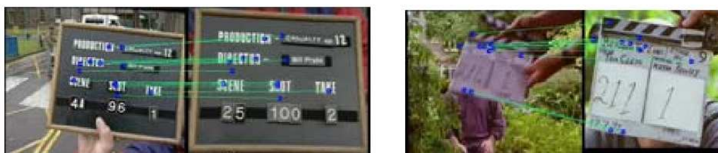
FIG. 2.1 – Détection des claps par correspondance de points clés.
