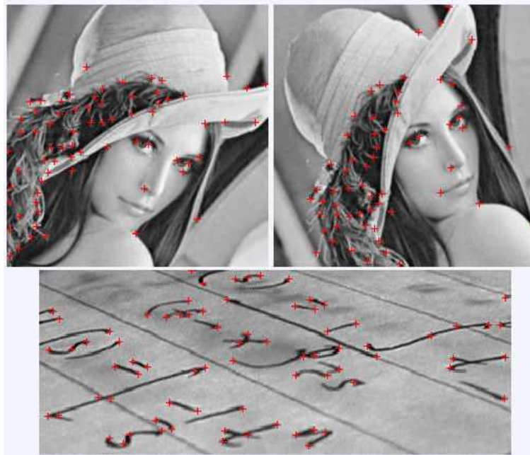
FIG. 3.3 – Exemples de détection de point clés par le détecteur de Harris.
