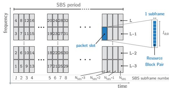
FIGURE 67 – Partage du groupement de ressources en slots pour paquets (packet-slots)
