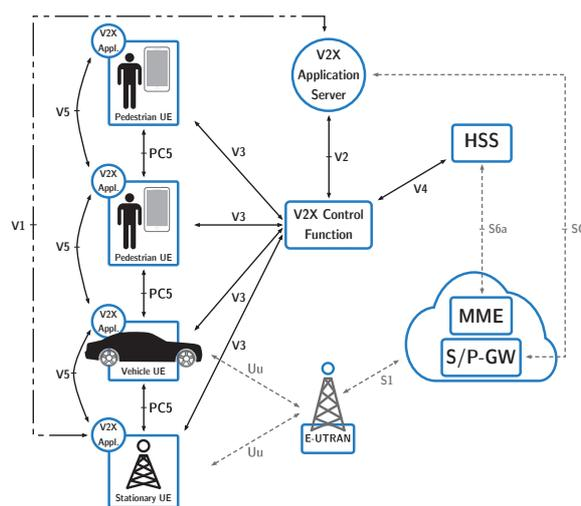
FIGURE 64 – LTE-based V2X : extension d'architecture pour scénarios non-roaming. Adaptée à partir de Figure 4.2.1.1-1 en [54]. Le lecteur est invité à consulter [54] et ses références pour une description détaillée des interfaces et des liens. Les lignes noires représentent les nouvelles interfaces LTE-V2X, les lignes grises pointillées représentent les interfaces déjà existantes. Le l'interface V1 est définie, mais pas encore spécifiée
