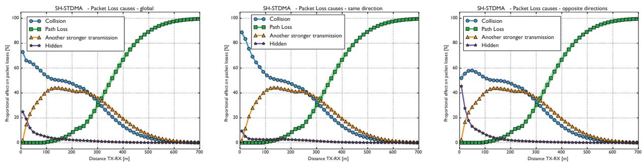
FIGURE 83 – Causes de perte de paquet pour **SH-STDMA** avec **HD**, 240 véhicules pour km **Gauche** : tous les véhicules ; **centre** : seulement couples **TX/RX** procédant dans la même direction ; **droite** : seulement couples **TX/RX** procédant en directions opposées
