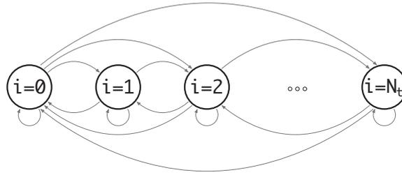
FIGURE 73 – Chaîne de Markov du processus de réservation des slots. La variable d'état  $i$  représente le nombre de terminaux qui ré-utilisent le slot  $\sigma_t$ .
