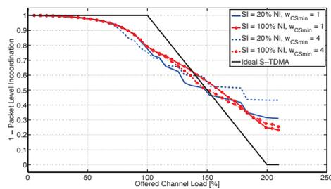
FIGURE 79 – Packet Level Coordination pour  $t_{min} = 3$  et  $t_{max} = 7$
