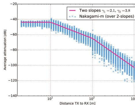
FIGURE 76 – Propagation à double pente avec fading Nakagami-m
