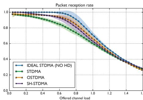
FIGURE 81 – Évaluation statique : **OSTDMA** vs **SH-STDMA** vs **STDMA**. Les surfaces colorées autour des courbes représentent l’intervalle de confiance à 95%
