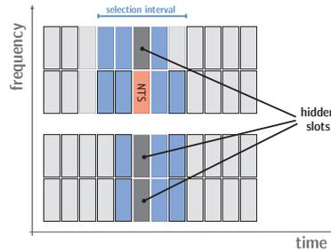
FIGURE 70 – STDMA : slots cachés due au half duplex
