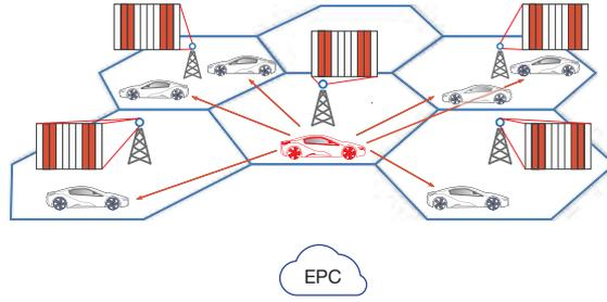
FIGURE 65 – Réserve des ressource semi-statique inter-cellule
