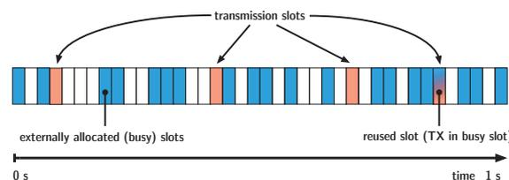
FIGURE 69 – **STDMA** : transmissions périodiques. Dans cet exemple, le transmetteur réserve  $r = 4$  slots de transmission, colorés en rouge. Les slots colorés en bleu sont 'externally allocated', soit réservés par des autres terminaux.
