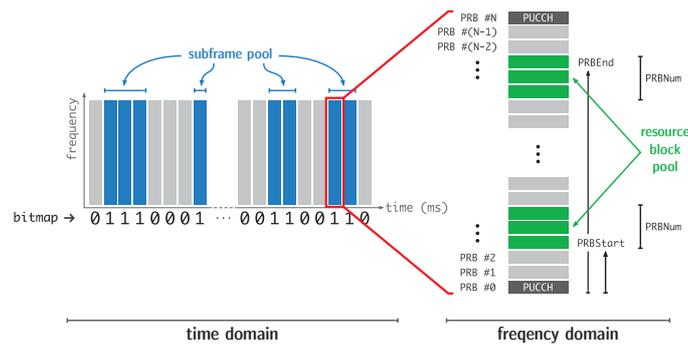
FIGURE 63 – LTE sidelink : disposition des ressources en temps/fréquence - groupement (pool) de sous-trames (subframes) et de resource blocks
